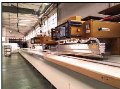
Confección soldadura alta frecuencia
