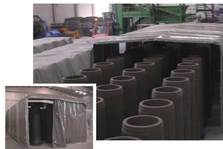
Ambos laterales del túnel irán pre-montados (aspas, tensores, escuadras, asas) para facilitar el montaje.
