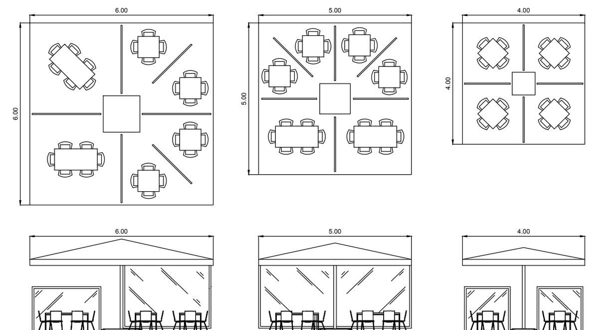
Esquemas de posibilidades y colocación de mesas en parasoles descentrados con base flexo en parasol de 3x3 y base de 75x75 en parasoles rectangulares.
