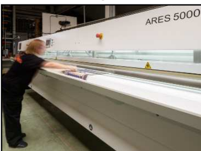
Confección soldadura alta frecuencia
