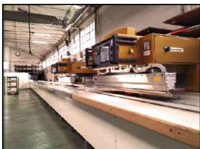
Confección soldadura alta frecuencia
