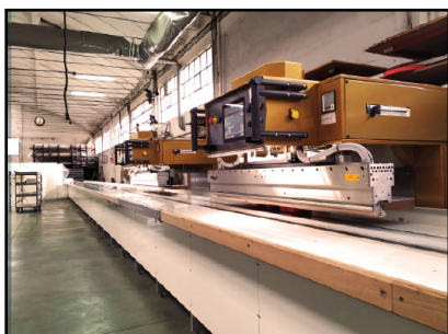
Confección soldadura alta frecuencia
