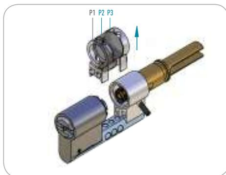
Retire la pieza extraíble P2 o P3 y, a continuación, la leva negra P1 tirando hacia arriba.
