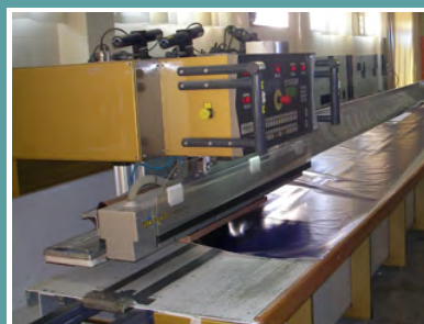
confección soldadura alta frecuencia
